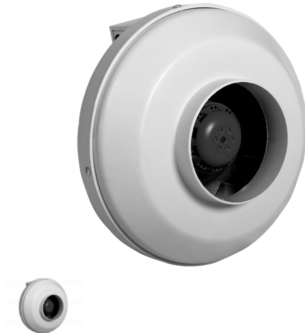
Разъемный коррозионно-стойкий корпус из композиционного материала с пониженной звукопроводимостью. EXTRA COOLING – технологическое решение с применением компактного блока мотор-колеса в центре воздушной струи, благодаря чему обеспечивается оптимальное охлаждение двигателя и длительный ресурс службы. В конструкции использована система рассекателей-завихрителей, существенно увеличивающая характеристику напора воздуха. Монтаж в любом положении.
