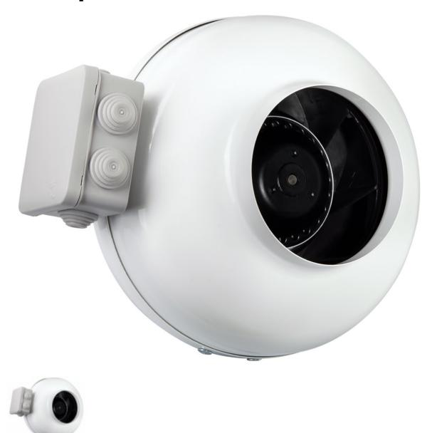
Разъемный корпус из оцинкованной стали. Мотор-колесо динамически сбалансировано в двух плоскостях. Встроенная термозащита двигателя с автоматическим перезапуском. Монтаж в любом положении.
