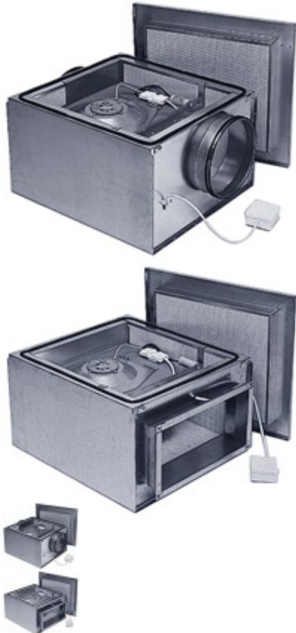
Все канальные вентиляторы IRE оснащены асинхронным двигателем с внешним ротором и уплотнёнными подшипниками, что увеличивает срок их службы. Корпус изготавливается из оцинкованной стали. Двигатель и рабочее колесо вентиляторов расположены на откидывающейся пластине, что делает доступ к ним лёгким, быстрым и удобным. Вентиляторы имеют внутренний 50 мм слой изоляции из минеральной ваты, покрытой грубой шерстяной тканью, что обеспечивает низкие шумовые характеристики.
