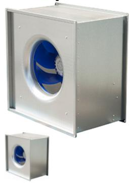
Канальные вентиляторы BFS оснащены асинхронным двигателем с внешним ротором и рабочим колесом с загнутыми назад лопатками. Корпус вентиляторов изготавливается из оцинкованной стали. Вентиляторы BFS предназначены для соединения с воздуховодами квадратного сечения. Степень защиты электродвигателя IP 44 или IP 54, клеммной коробки - IP 54. Вейжие:вПорасбер рейтингавару
