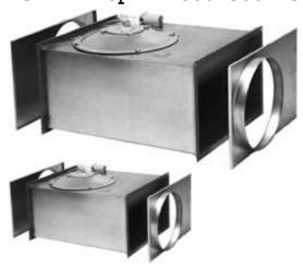
Канальные вентиляторы RK оснащены асинхронным двигателем с внешним ротором и рабочим колесом с загнутыми вперед лопатками. Двигатель и рабочее колесо вентилятора расположены на откидывающейся пластине, что делает доступ к ним лёгким, быстрым и удобным. Корпус вентилятора изготавливается из оцинкованной стали.Вентиляторы RK предназначены для соединения с воздуховодами прямоугольного сечения. Степень защиты электродвигателя IP 44, клеммной коробки – IP 54.
