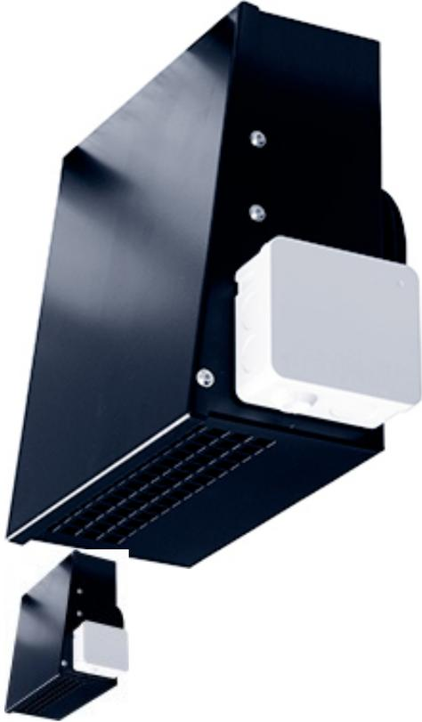
Настенные вентиляторы RS оснащены асинхронным двигателем с внешним ротором и рабочим колесом с загнутыми назад лопатками. Корпус вентиляторов изготавливается из оцинкованной стали, корпус дополнительно окрашивается в черный цвет. Вентиляторы имеют типоразмеры от 125 до 160 мм и предназначены для соединения с воздуховодами круглого сечения. Степень защиты электродвигателя IP 44, клеммной коробки – IP 54.
