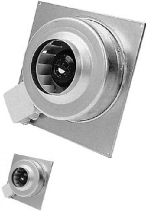
Настенные вентиляторы KVFU оснащены асинхронным двигателем с внешним ротором и рабочим колесом с загнутыми назад лопатками. Корпус вентиляторов изготавливается из оцинкованной стали. Вентиляторы KVFU имеют типоразмеры от 100 до 315 мм предназначены для соединения с воздуховодами круглого сечения. Степень защиты электродвигателя IP 44, клеммной коробки – IP 54.
