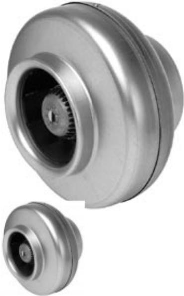
Канальные вентиляторы СК оснащены асинхронным двигателем с внешним ротором и рабочим колесом с загнутыми назад лопатками. Корпус вентиляторов изготавливается из оцинкованной стали. Вентиляторы СК имеют типоразмеры от 100 до 315 мм и предназначены для соединения с воздуховодами круглого сечения. Степень защиты электродвигателя IP 44, клеммной коробки – IP 54.
