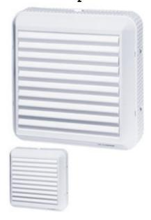
Оконные осевые вентиляторы Ventilor с автоматически или вручную открывающимися жалюзи предназначены для непосредственного (без воздуховода) удаления или подачи воздуха. Вентиляторы изготавливаются из пластмассы светлых тонов и устанавливаются на стекле или на панели. Конструкция наружной решётки предусматривает защиту от атмосферных осадков. Все модели этой серии выпускаются в брызгозащищенном исполнении (степень защиты IP X4). Вейжите:вПорасбею рейтингавару
