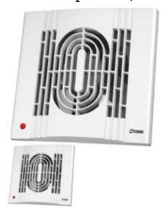
Стандартное исполнение с автоматическими жалюзи, датчиком влажности и встроенным электронным таймером. Вентилятор включается автоматически при превышении заданного на датчике уровня влажности (в диапазоне 40-90%) и выключается при понижении влажности с задержкой по таймеру. Таймер устанавливается на время от 2 до 25 мин.
