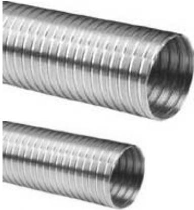
Полужёсткие воздуховоды, предназначенные для принудительной системы вентиляции и кондиционирования воздуха, воздушных выбросов с малым, средним и высоким давлением. Воздуховоды АрктосПВ изготавливают из алюминия. Они легко соединяются с каналами круглого и овального сечения. Рабочая температура от 30°C до +250°C, максимальное давление 5000 Па, максимальная скорость потока 30 м/с. Стандартная длина воздуховода в одной упаковке составляет 5 м.
