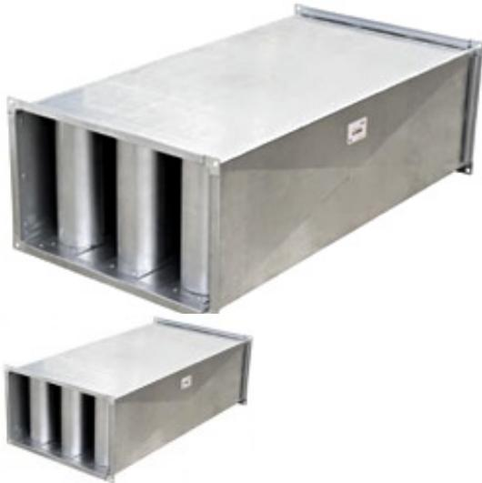
Пластинчатые шумоглушители RSA предназначены для снижения аэродинамического шума в воздуховодах прямоугольного сечения. Шумоглушители устанавливаются независимо от направления движения воздуха. Для достижения максимальной эффективности шумоподавления перед шумоглушителем рекомендуется предусмотреть прямолинейный участок длиной не менее 1 м. Корпус шумоглушителей изготавливается из оцинкованной стали. Внутри корпуса установлены звукопоглощающие пластины из минерального волокна.
