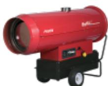
Регулировка интенсивности нагрева;Камера сгорания из нержавеющей стали толщиной 1,2 мм с 4-х ходовым теплообменником;Уникальная долговечная горелка собственной разработки;Ограничительный термостат, предохранительный термостат;Отдельный забор воздуха для горелки;Мобильная (PHOEN) и подвесная (PHOEN / S) версии.
