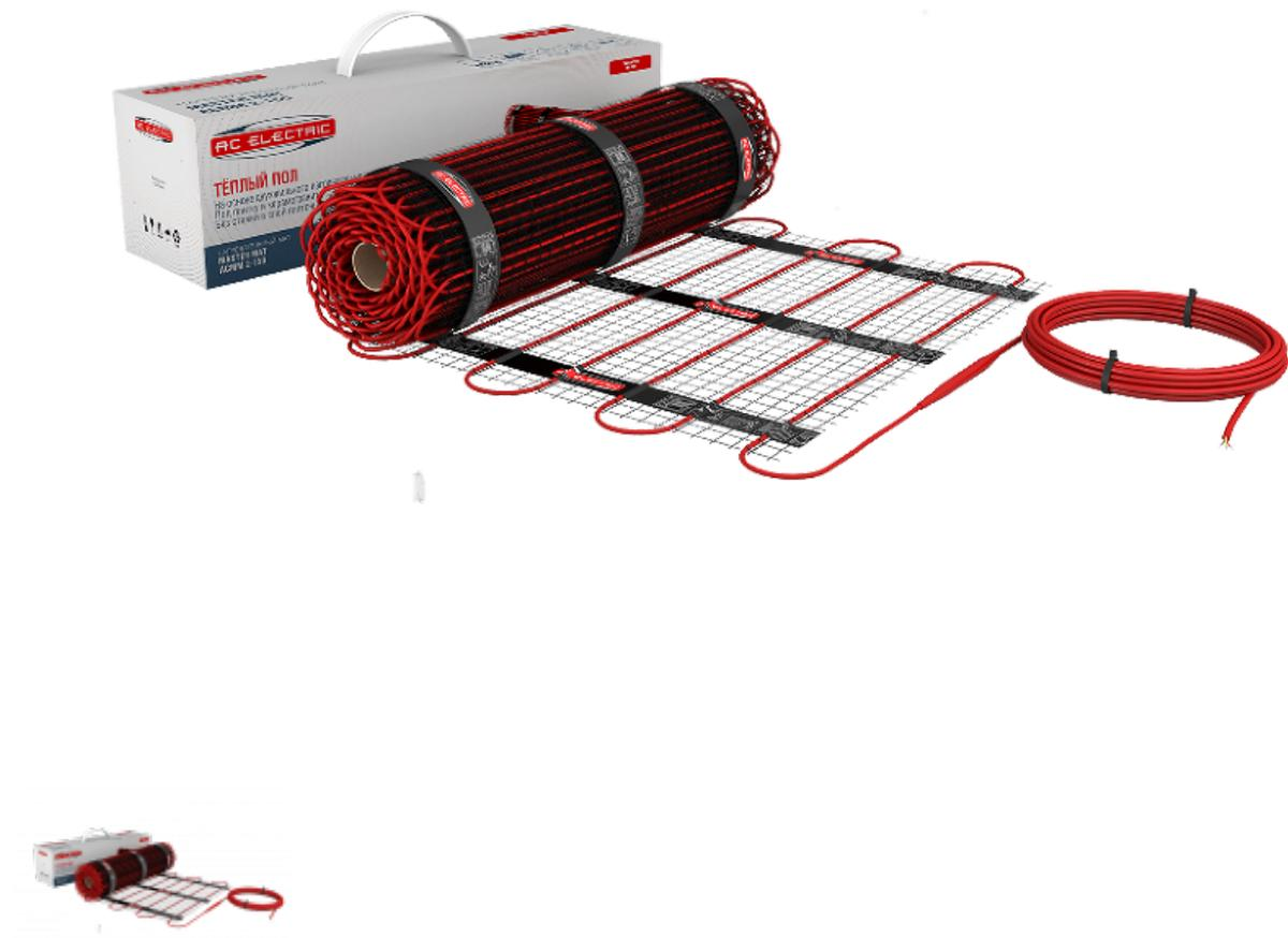
Двужильный кабельный мат, обе жилы греющие. Одностороннее подключение, основа из стекловолокна, укладка в тонкий слой плиточного клея, 4,1 мм толщина, герметичная муфта. Диаметр муфты практически равен диаметру кабеля. Мощность 150 Вт/м<sup>2</sup>. Гарантии – 20 лет. Сделано в России.
