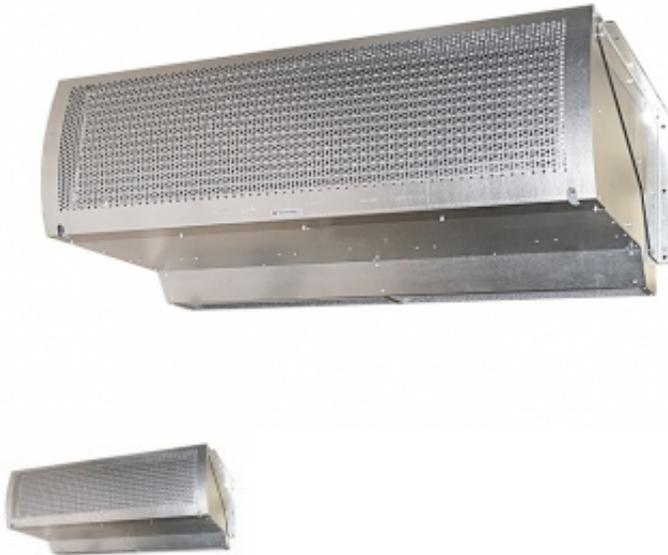
Тепловая завеса для защиты ворот высотой от 4 до 6 м предприятий, железнодорожных депо, складов. Благодаря сильному воздушному потоку эффективно защищают проемы промышленных зданий. Установленный угол сопла завесы – 20°. Под заказ изготавливается завеса IP44. Комплектация Воздушно-тепловая завеса, пульт управления HL10, комплект крепежных кронштейнов, паспорт.
