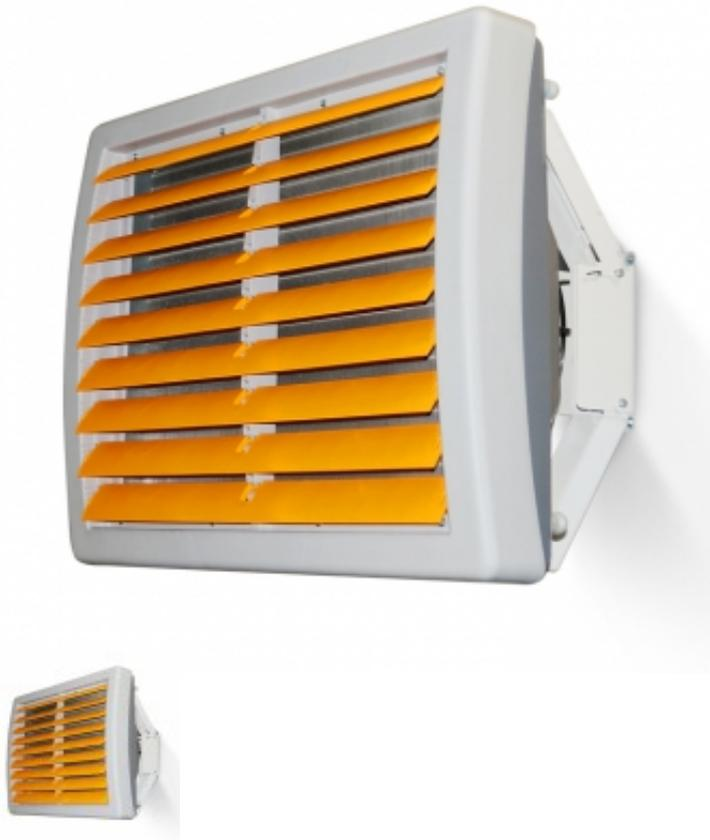
Тепловентилятор КЭВ-110М4W4 с водяным источником тепла для отопления офисных, административных, складских, промышленных и других помещений. Монтаж – вертикальный или горизонтальный. Монтажный кронштейн с регулируемыми углами поворота и наклона тепловентилятора, и регулируемые жалюзи позволяют направить воздушную струю в рабочую область. Комплектация Тепловентилятор, пульт управления HL10, паспорт, крепежный кронштейн.
