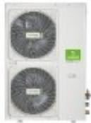
Серия моноблочных чиллеров LUC-EHAA оснащена ротационным компрессором DC-инвертор, а также DC-моторами вентиляторов конденсатора. Это позволяет плавно регулировать холодопроизводительность чиллера, что обеспечивает эффективное энергопотребление и снижение уровня шума. Моноблочный чиллер со встроенным гидромодулем предоставляет возможность осуществлять эксплуатацию в выбранной комплектации без необходимости подбора насоса и других компонентов, уже вошедших в состав чиллера.
