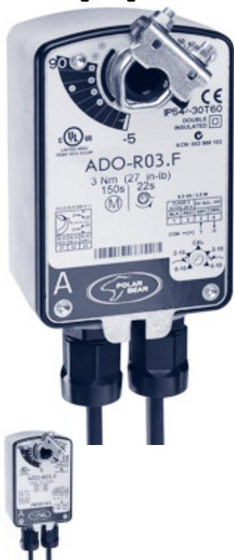
Электрические привода Polar Bear разработаны специально для использования с воздушными заслонками в системах вентиляции и кондиционирования. В каждый привод встроена система «Safety» с возвратной пружиной, обеспечивающая при аварийном отключении напряжения полное закрытие воздушной заслонки для предотвращения размораживания водяных теплообменников.
