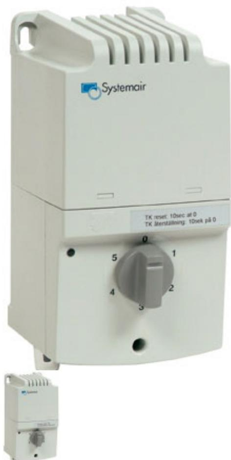
Однофазный регулятор, который регулирует скорость вентиляторов, изменяя подаваемое напряжение (пять ступеней), оснащенный защитным устройством двигателя. Это устройство прекращает подачу напряжения к вентилятору при активации встроенных термоконтактов двигателя вентилятора. Возврат в рабочее состояние осуществляется при установке рукоятки в положение 0 на 10 секунде.
