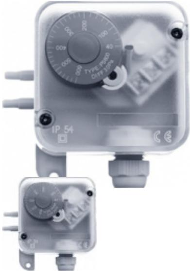
Дифференциальные реле давления DPS предназначены для контроля падения давления на элементах систем вентиляции и кондиционирования, например, степени загрязнения фильтра, напора вентилятора и т. д. Поставляется с двумя метрами гибкой трубки и двумя пластиковыми штуцерами для монтажа на воздуховоде.
